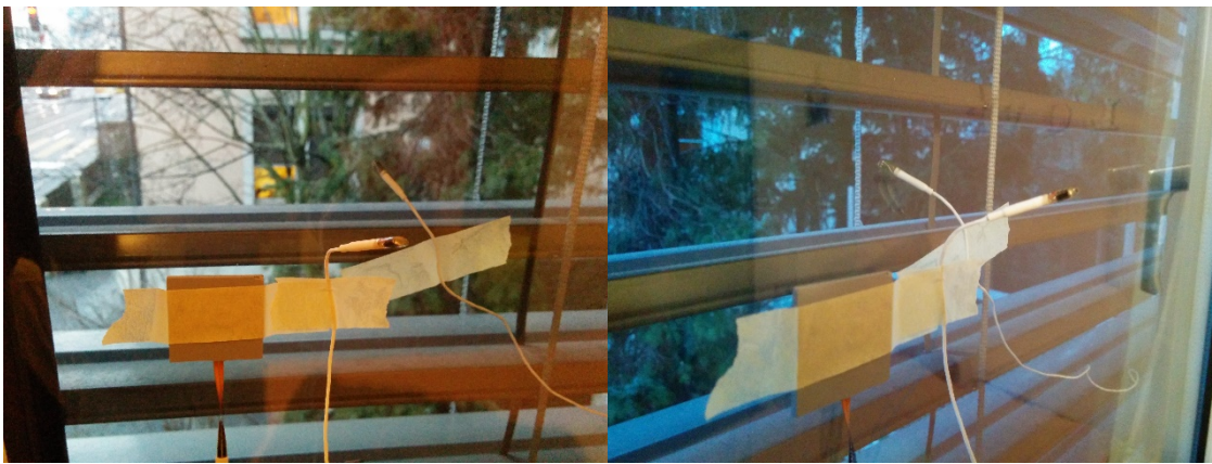
Abbildung 1: Messaufbau; Fenster mit metallischer Sonnenblende; Wärmeflussensor mit 2 Temperatursensoren, einer innen und einer außen, beide ungefähr 3-5 cm Abstand zum Glas.
