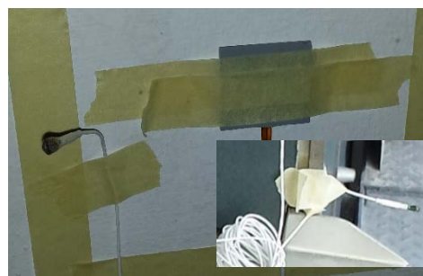
Abbildung 2: Messaufbau; Wärmeflussensor und Innentempersensoren, unten rechts: Außentempersensoren
