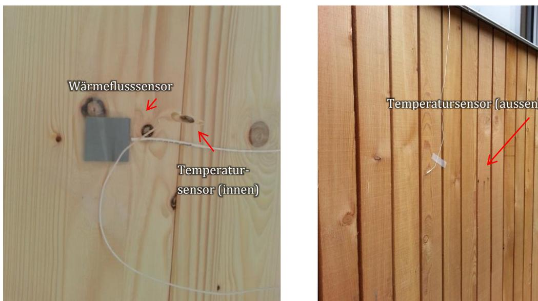
Abbildung 3: Befestigung des Wärmeflussensors und Innentemperatursensor (links), Befestigung vom Aussentemperatursensor (rechts).
